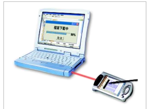
圖 4-11 紅外線傳輸 在傳輸訊號時，必須以點對點的方式傳輸
