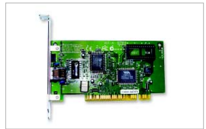
圖 4-20 網路卡 PCI 介面，但有些主機板已內建有網路卡的功能
