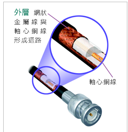
圖 4-7 同軸電纜 傳輸距離與抗擾性皆優於雙絞線
