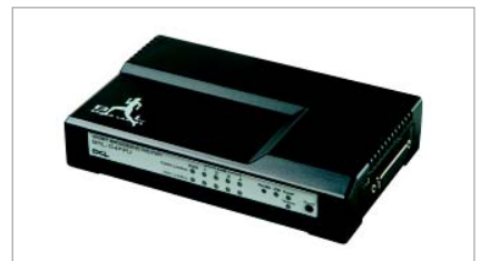
圖 4-25 路由器 用來提供資料封包最佳的傳輸路徑選擇
