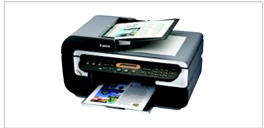
圖 2-36 多功能事務機 結合掃描器、印表機及傳真功能的事務機
