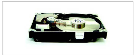
圖 2-19 硬式磁碟機 由數個磁盤組成，具有容量大、存取速度快的優點
