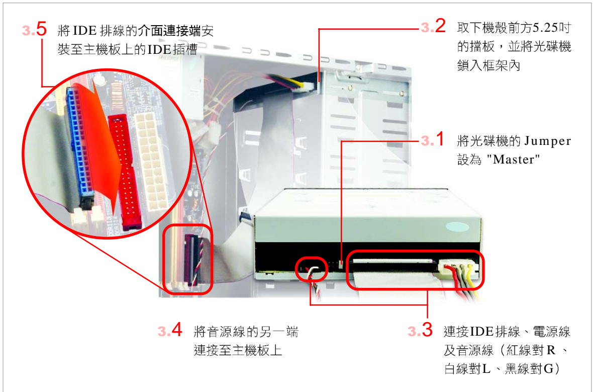
圖 2-51 安裝光碟機步驟 只要按照步驟 3.1 ~ 3.5，即可順利安裝 IDE 介面的光碟機
