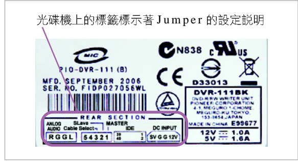
圖 2-54 Jumper 說明 光碟機上的 Jumper 設定說明
