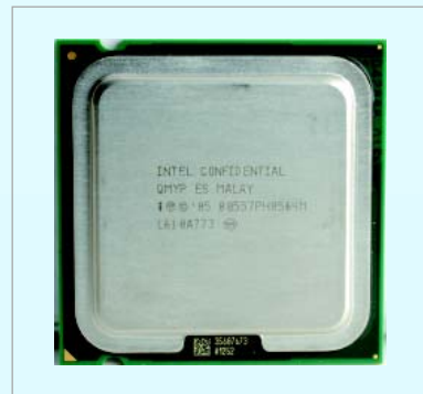
圖 2-10 四核心處理器 這種 CPU 將能大幅提昇電腦的運作效能
