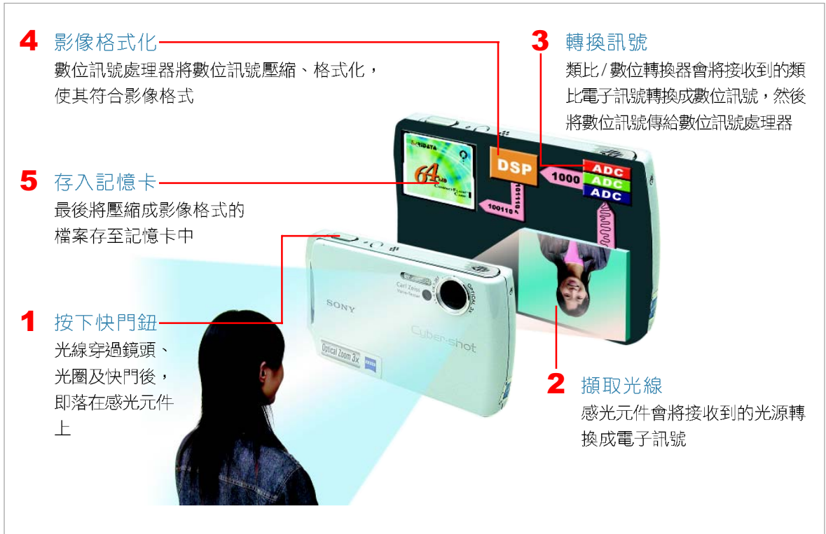
圖 2-28 數位相機的運作原理 將感光元件所擷取到的光源，經轉換器轉換處理成數位資料
