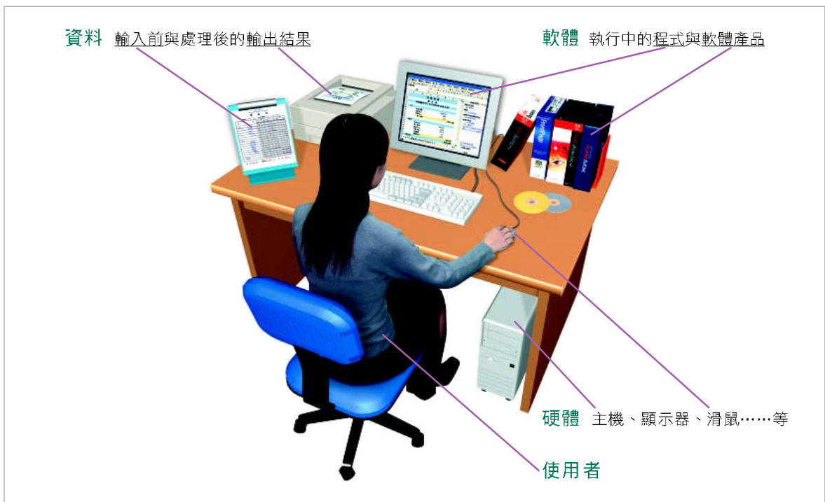
圖 1-9 電腦系統 一個完整的電腦系統是由硬體、軟體、資料及使用者所組成
