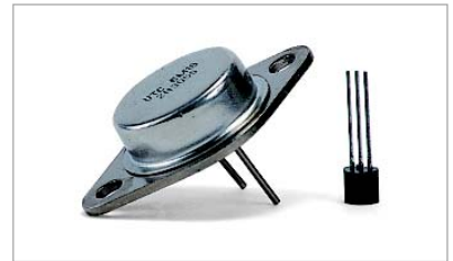
圖 1-3 電晶體 約為真空管 1/20 的大小，耗電量較少，不易發熱
